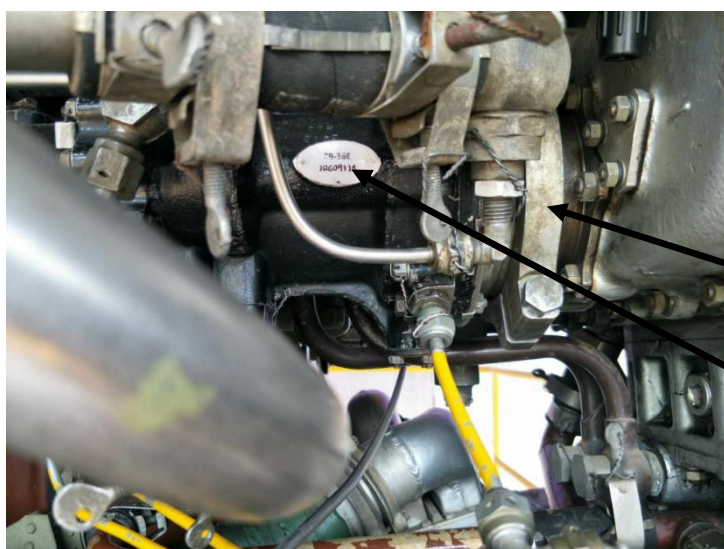
图 8 燃油泵和固定卡环位置图
