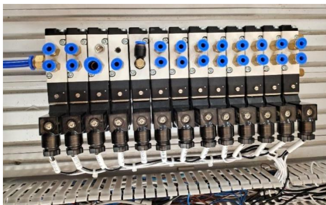
图 A-6 组装好的电磁阀
