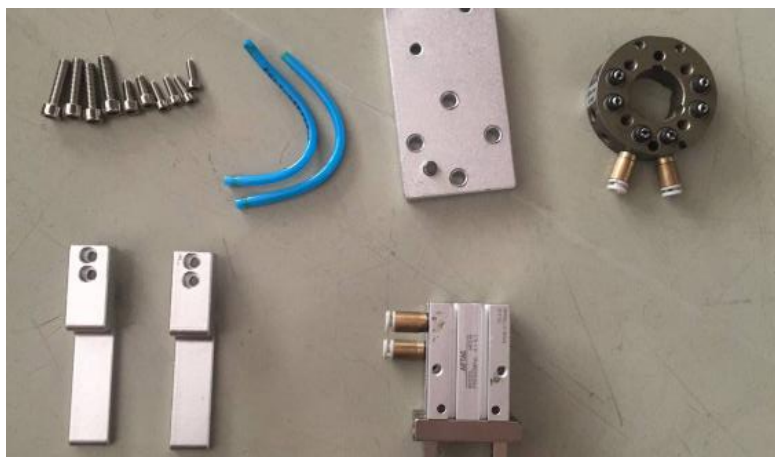
图 A-9 夹爪工具拆散的零件
