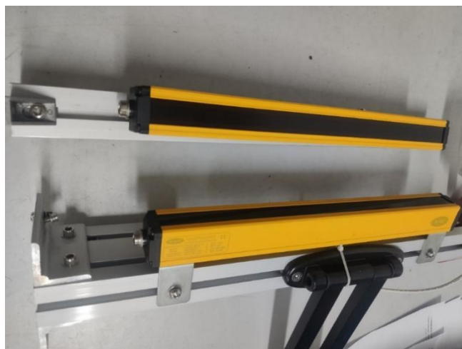
图 A-2 光栅装配图纸
