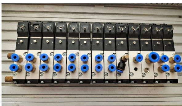
图 A-4 安装排列好的电磁阀
